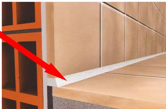
*Dettaglio piede pareti piastrellate: stucco a base siliconica o giunto elastico*
