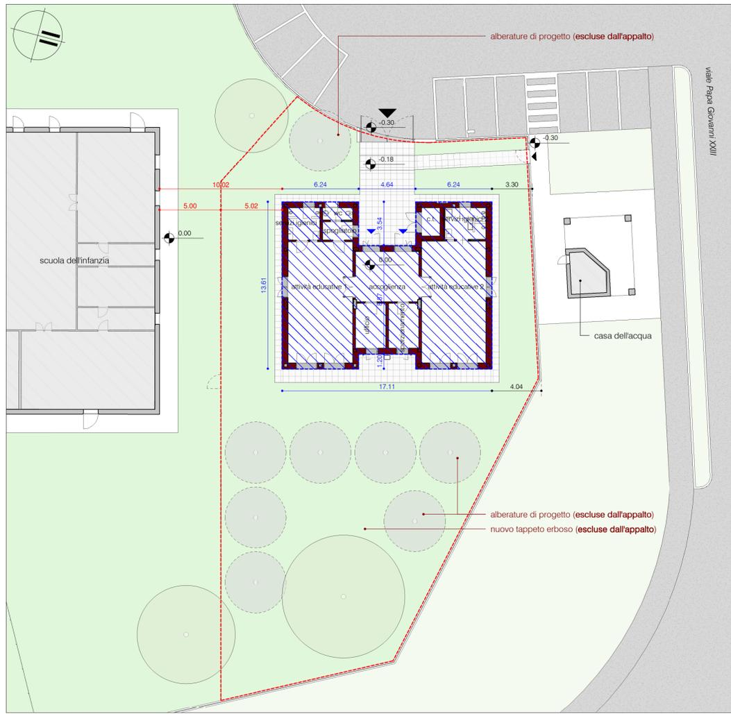
stato di progetto: planimetria generale scala 1:200
